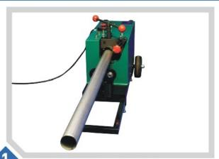
將喉管套入擴管槽,調緊穩定軸
