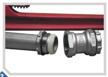
將矽膠圈套在已套螺母及擴管 的管口上。 (矽膠圈斜面對向管口)
